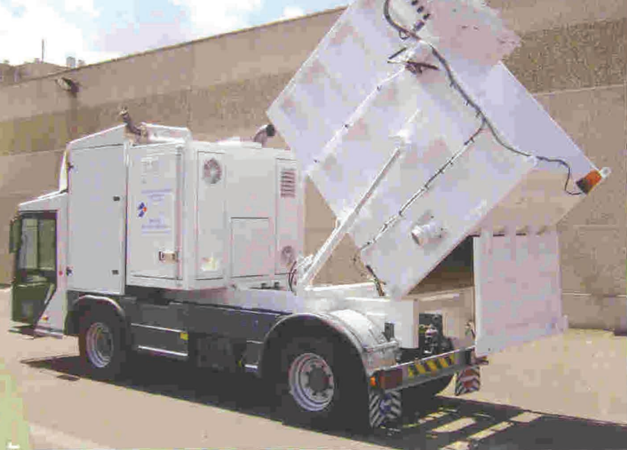
Standard Industrie International a conçu le Valnet comme un véhicule léger d'aspiration destiné au nettoyage et au pompage de produits secs et en vrac
