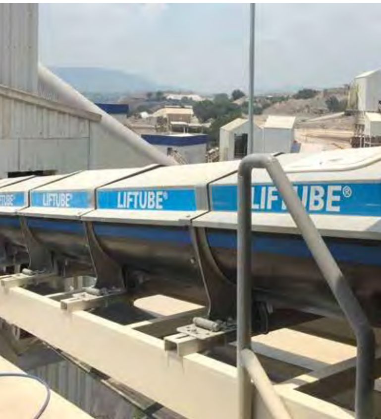
Exemple de protection du convoyeur dans une carrière de chaux.
